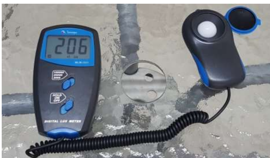
Figura 18 – Iluminância da Lâmpada LED.
