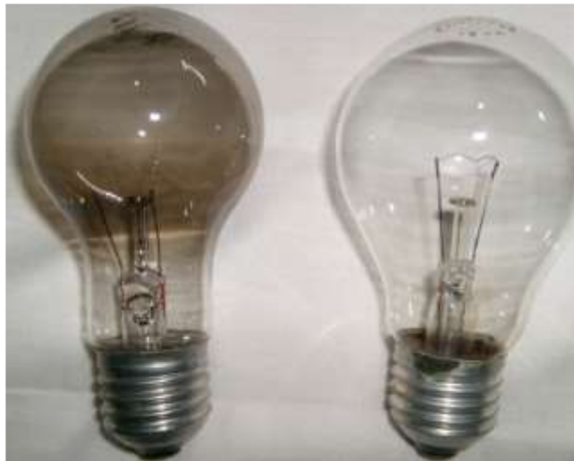
Figura 4 – Exemplo de Depreciação do Fluxo Luminoso
