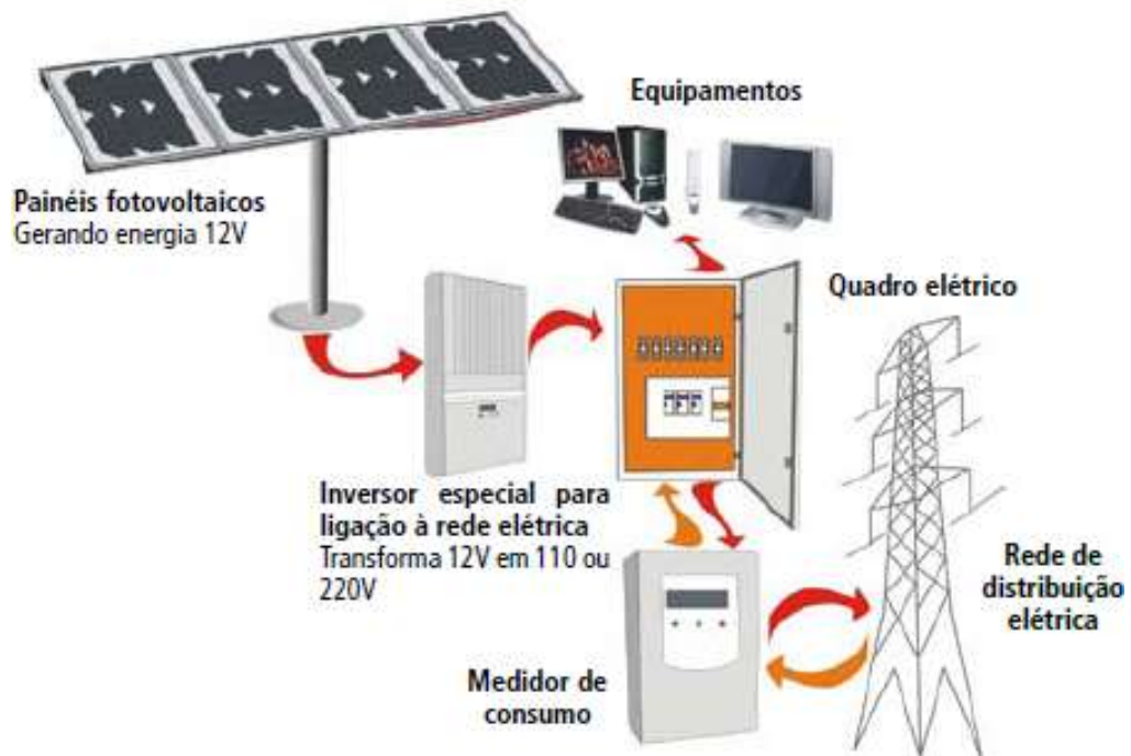
Figura 5 – Exemplo de Sistema Fotovoltaico Interligado à Rede
