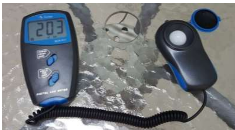
Figura 15 – Iluminância da Lâmpada Fluorescente.
