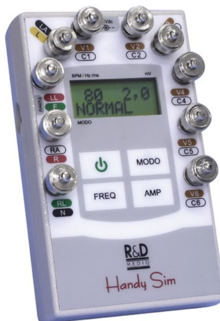
Figura 25 – Simulador de Sinais Cardíacos HS-15
