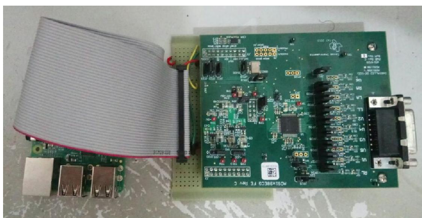
Figura 33 - Raspberry Pi e ADS1X98ECG FE conectados pela placa desenvolvida
