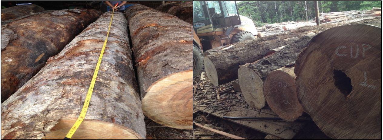
Figura 10: Mensuração do comprimento da tora e marcação da tora.
