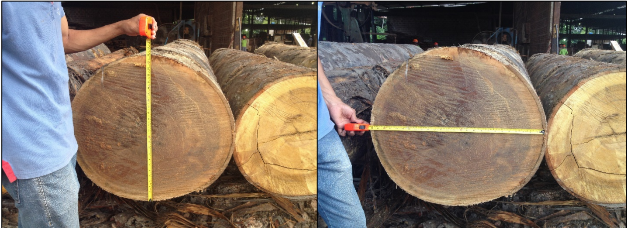
Figura 9: Mensuração do diâmetro médio da tora (Db;Dt).
