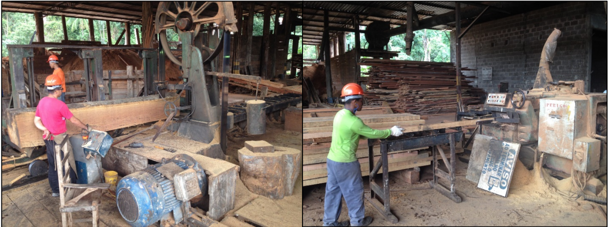
Figura 7: Desdobro da Tora; Transformação da madeira serrada
