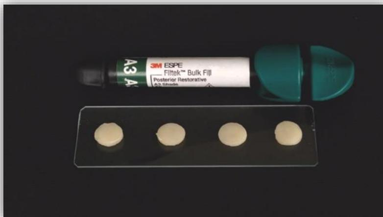
**Figura 6. Espécimes da resina Filtek Bulk Fill em forma de disco representando cada Grupo.**
