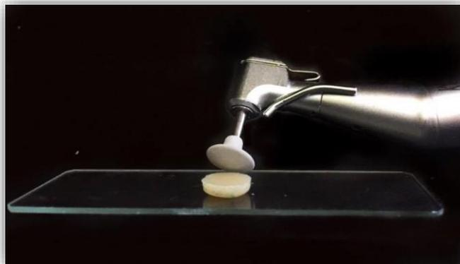
**Figura 8. Polimento dos disco com taças de borracha.**
