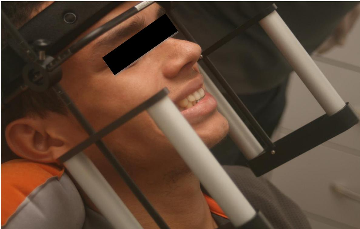
Figura 9. Realização do teste com cinesiógrafo.
