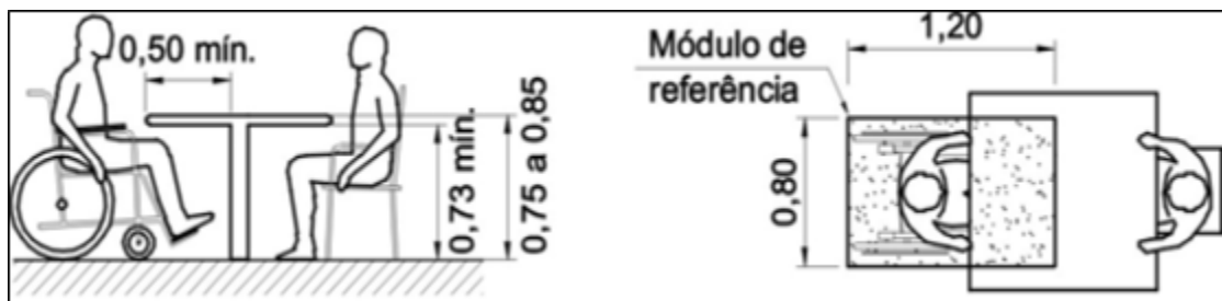
Figura 21: Modelo da mesa de acordo com a norma Fonte: Guia prático de Acessibilidade / Norma ABNT 9050/2004
