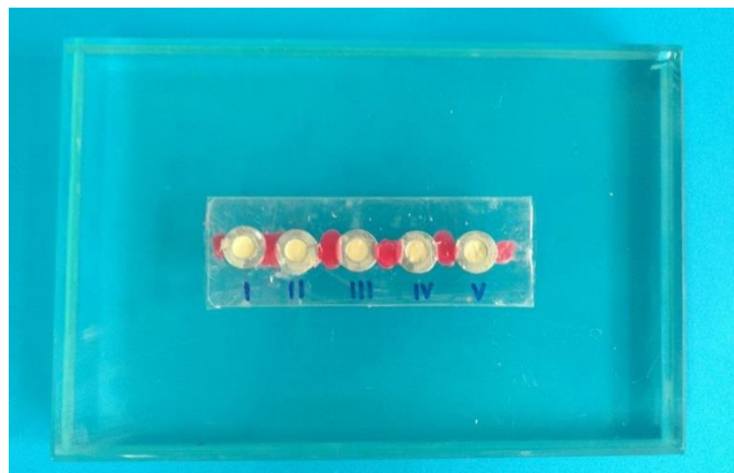
Figura 3. Os cinco moldes de anéis metálicos preenchidos com o cimento endodôntico Ah plus.
