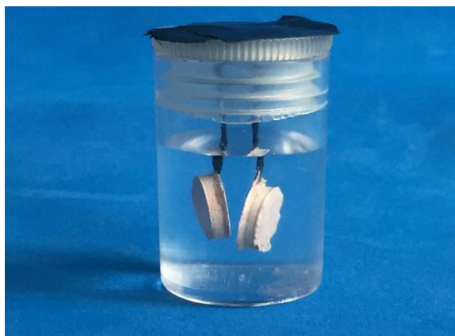
Figura 11. Amostra suspensa no interior de um recipiente de plástico contendo 7,5 mL de água destilada e deionizada, não permitindo que tocasse nas paredes.
