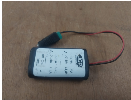
Figura 30 – Bateria dos Motores
