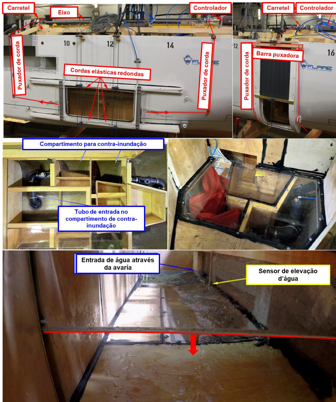
Figura 15. Exemplo da configuração de um experimento para estudar o problema de alagamento em uma embarcação.
