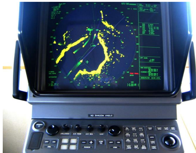
Figura 25. Um sistema de típico de bordo Radar/ARPA.
