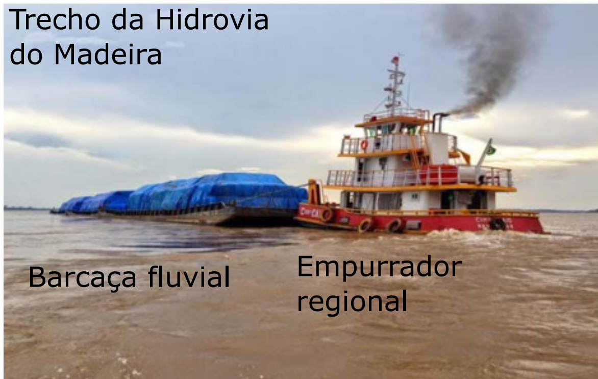
Figura 3 – Comboio fluvial (barcaça e empurrador) em navegação na hidrovia do rio Madeira.
