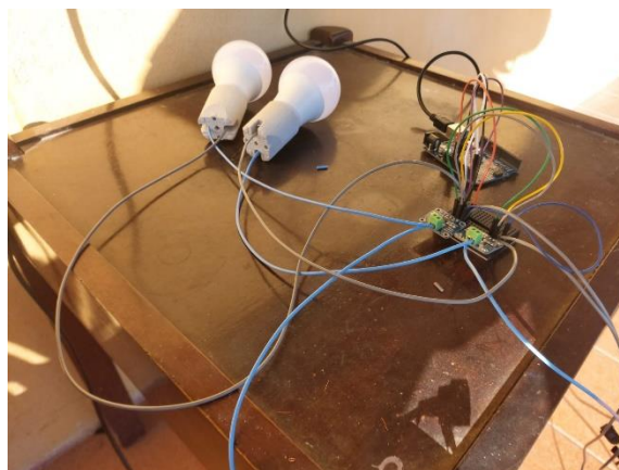
Figura 36: Sensores ligados às lâmpadas
