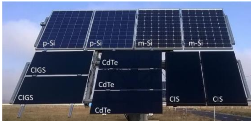
Figura 5: Tipos de módulos fotovoltaicos
