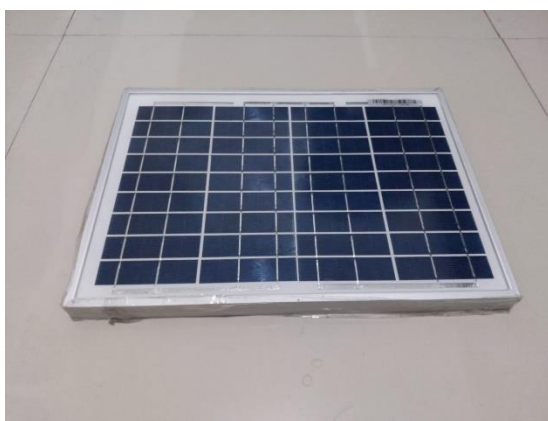
Figura 19: Módulo fotovoltaico de 10W
