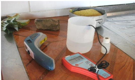
Figura 4: medida do ph da água
