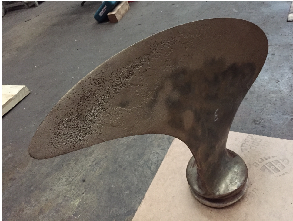
Figura 13 – Danos causados pela cavitação nas pás do hélice.
