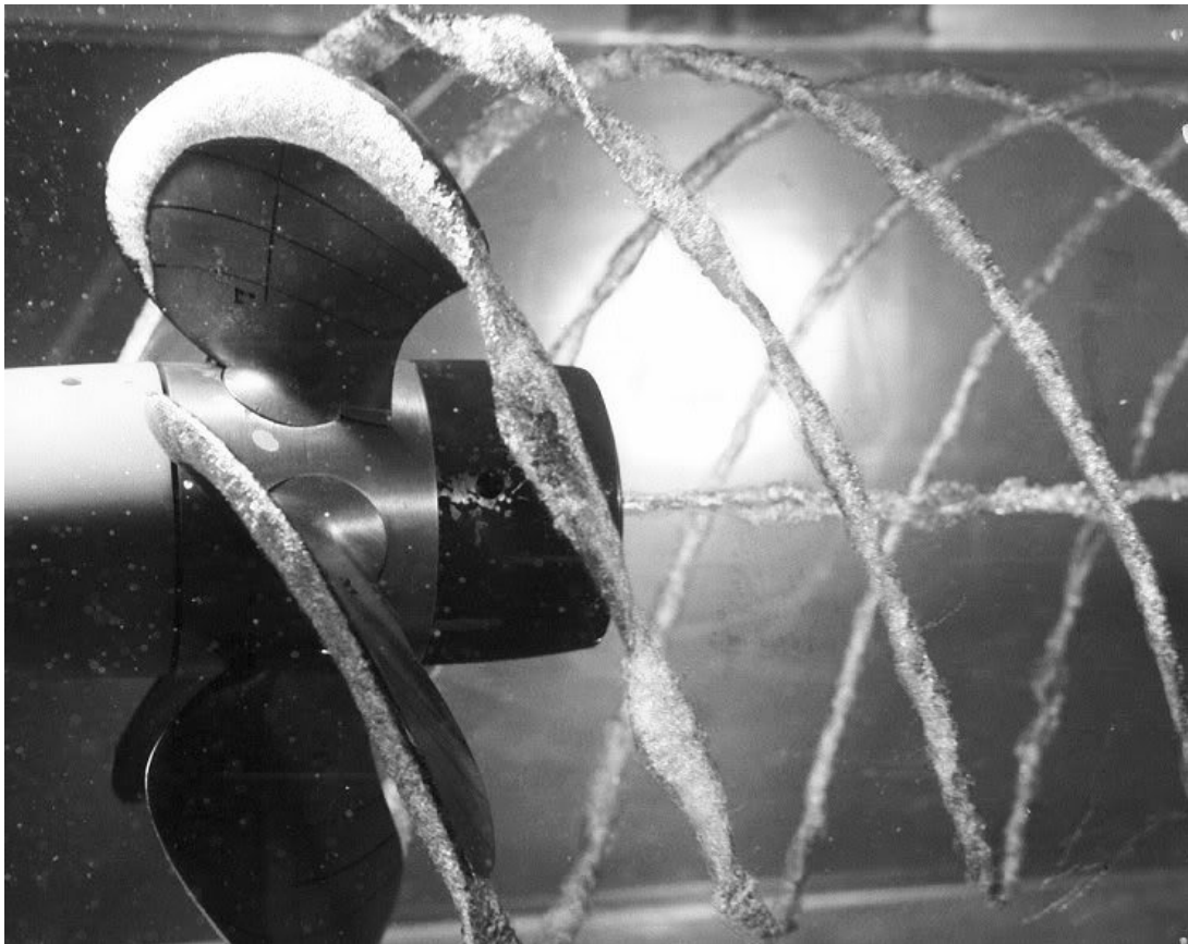
Figura 12 – Cavitação ocorrendo nas pontas das pás de um propulsor.
