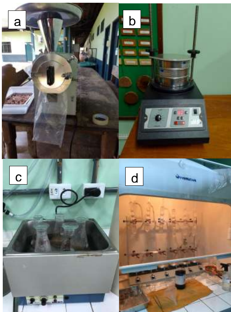
Figura 3 – a) moinho de facas; b) agitador de peneiras; c) extração em água quente; d) extração em aparelho soxhlet.
