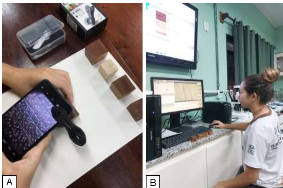
Figura 3 – Captura das macrofotografias com auxílio de uma lente macroscópica de 24x de aumento(A); Utilização do estereomicroscópio com sistema fotográfico e software para análise de imagens (B).
