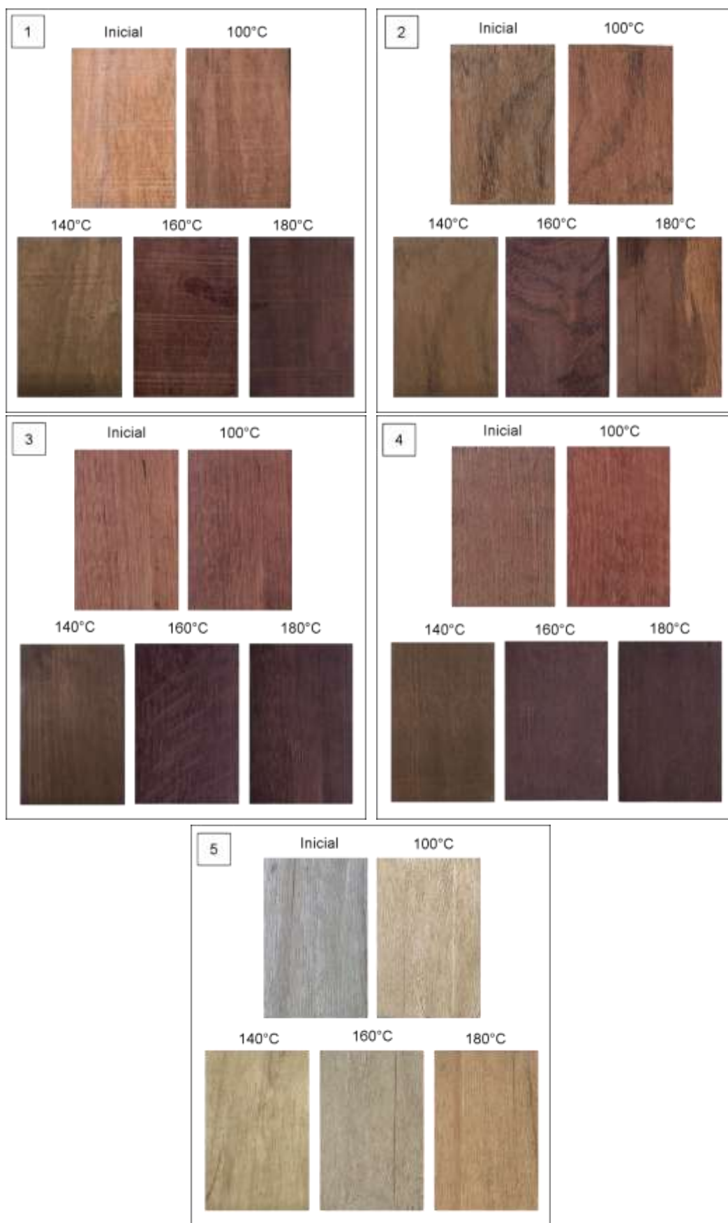
Figura 13 – Alterações das cores das madeiras temoretificadas. Fonte: Autor (2022).
