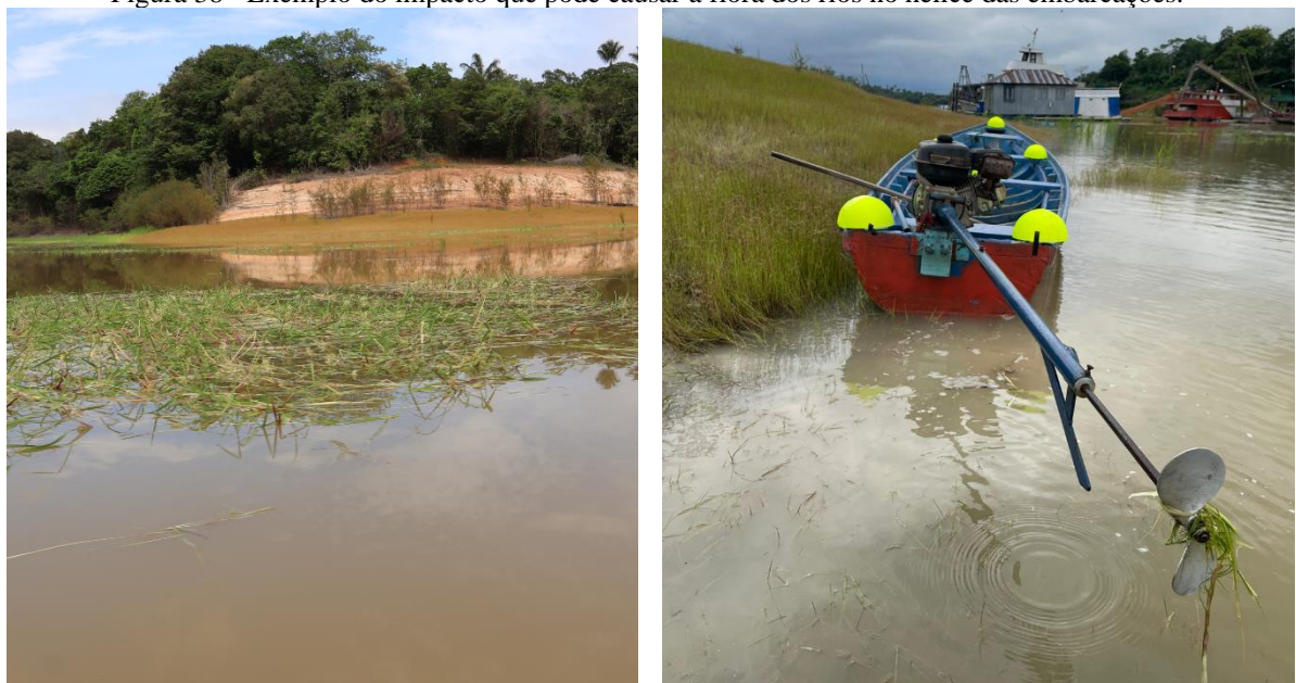
Figura 38 - Exemplo do impacto que pode causar a flora dos rios no hélice das embarcações.
