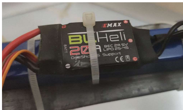
Figura 45. Detalhe do ESC instalado no modelo.
