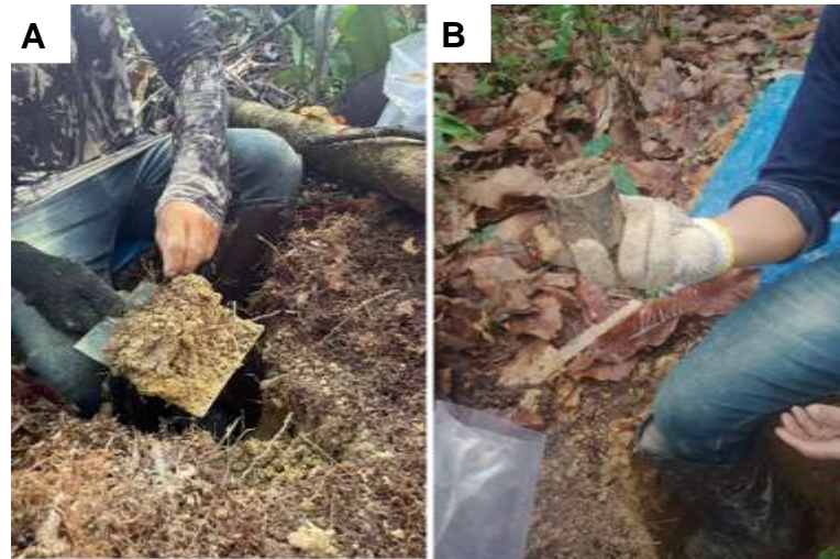
Figura 4 - Coleta das amostras. (A) Amostra com estrutura deformadas; (B) Amostras com estrutura preservadas
