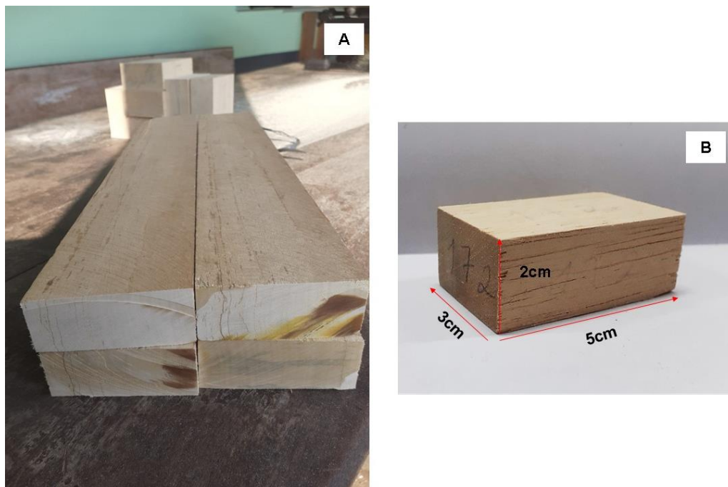
Figura 4 – Peça de madeira da espécie de Simarouba amara (A); corpo de prova com dimensões nominais (B)
