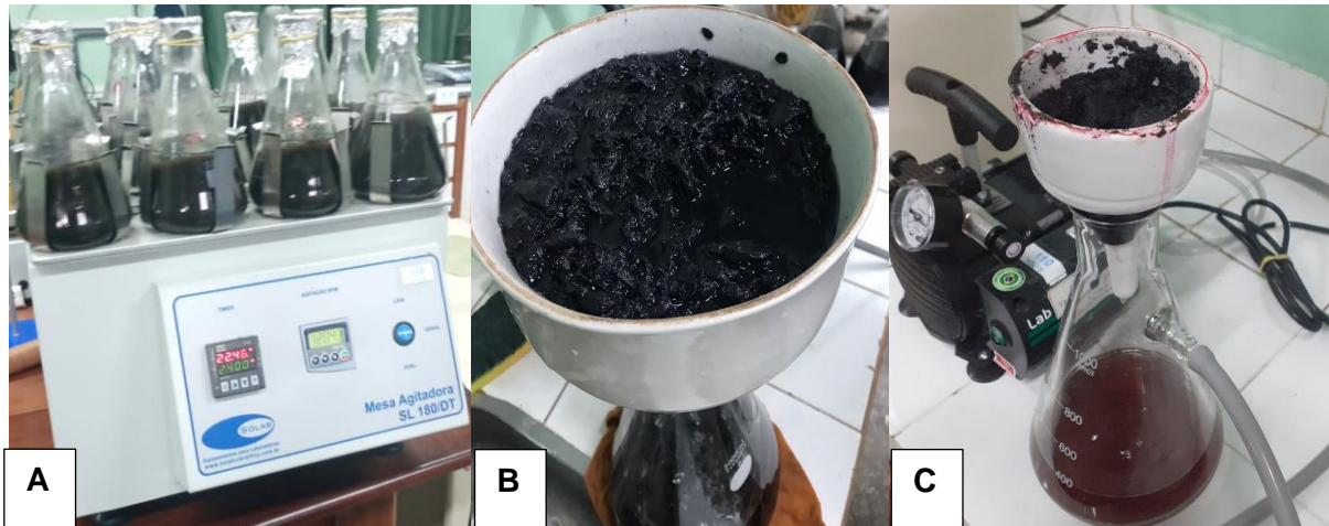
Figura 5: (A) Mesa agitadora; (B) Funil de Buchner e (C) kitassato acoplado à uma bomba à vácuo pressão.
