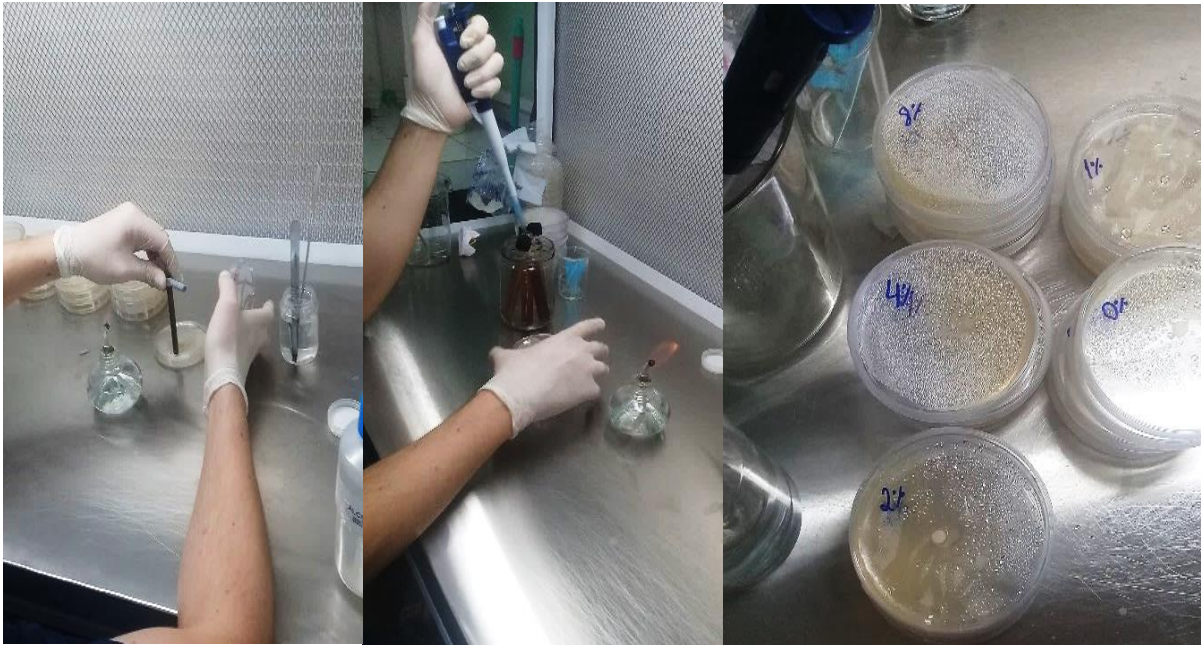
Figura 7: Preparo das placas com as diferentes concentrações testadas e deposição dos inóculos fungo ( Gloeophyllum trabeum ). Fonte: Autor (2023).
