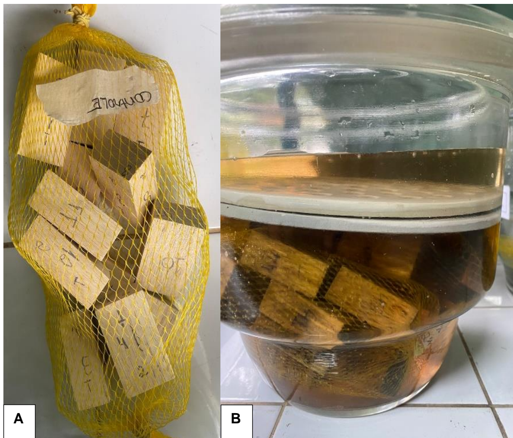
Figura 14: (A) Amostras em redes plásticas; (B) Saturação das amostras em água destilada.
