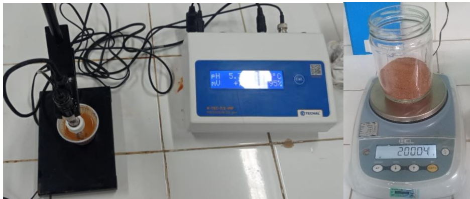
Figura 10: Obtenção de pH e retenção de água no solo. Fonte: Autor (2023).
