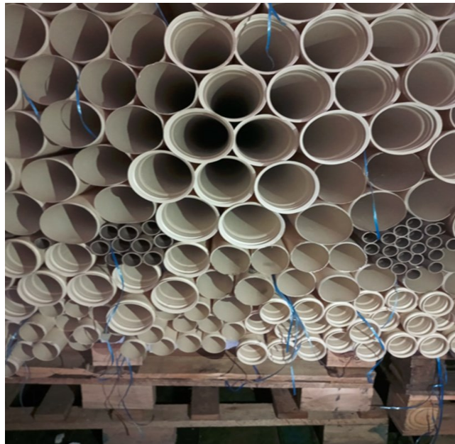
Figura 13 - Registro do Carregamento de Tubos de Maneira Inadequada
