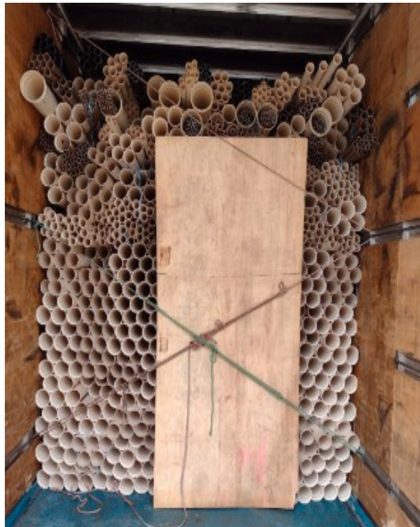
Figura 23 - Registro de um Carregamento Inadequado.
