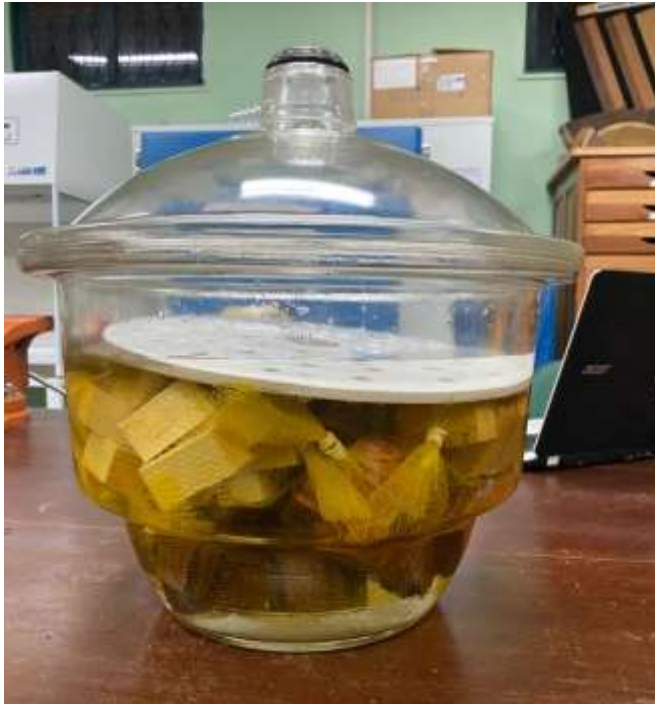
Figura 12- amostras colocadas para saturar em água destilada.
