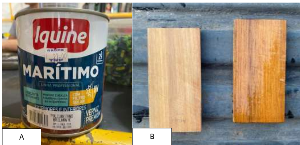
Figura.6- (A) verniz marítimo da marca Iquine; (B) diferença de uma madeira com aplicação de verniz e outra sem a aplicação
