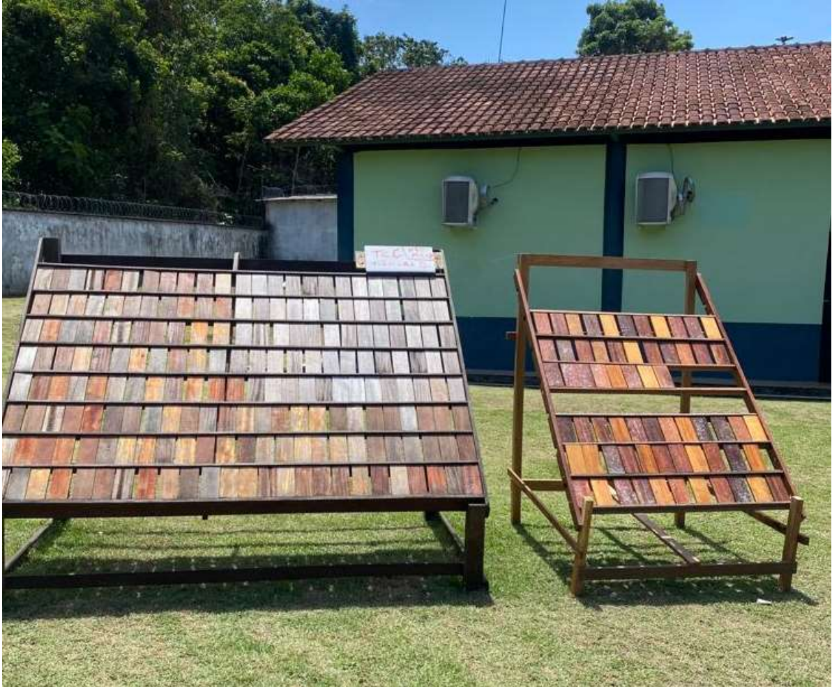
Figura 8 – Amostras dispostas no cavalete em inclinação de 45° e orientadas segundo o eixo leste-oeste.
