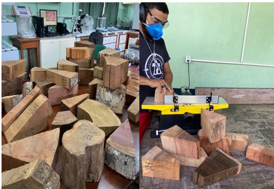
Figura 2 - Aparelhamento das amostras no formato de cunha
