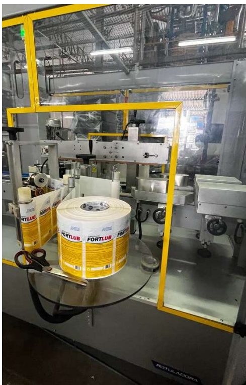
Figura 38 – Envasamento do produto – Etapa de rotulação - Maquinário (rotuladora)
