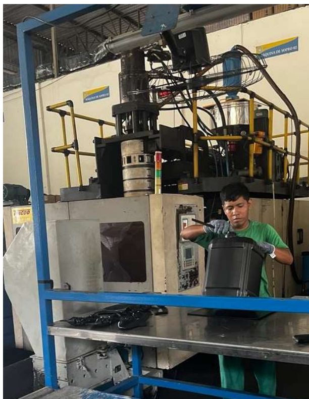
Figura 21 – Após o processo de reciclagem, se identificada não-conformidade é ajustado e devolvido o excesso extraído ao processo
