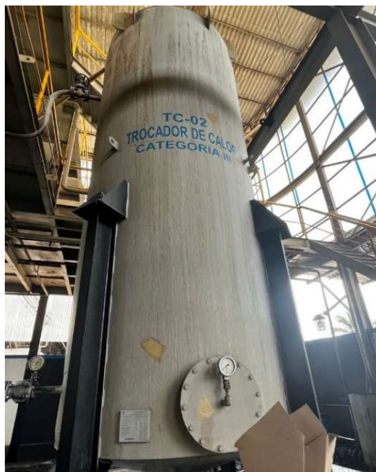
Figura 32 – Maquinário do processo industrial (aquecimento do óleo)
