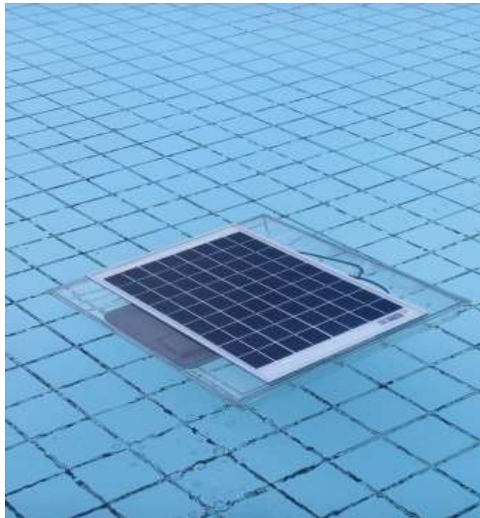
Figura 54: Protótipo mecânico estável após 1 hora na água
