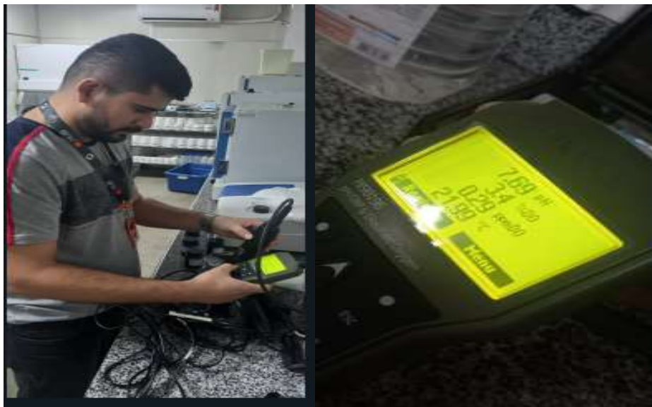
Figura 30- Leitura dos parâmetros da água com a sonda comercial HANNA HI98194
