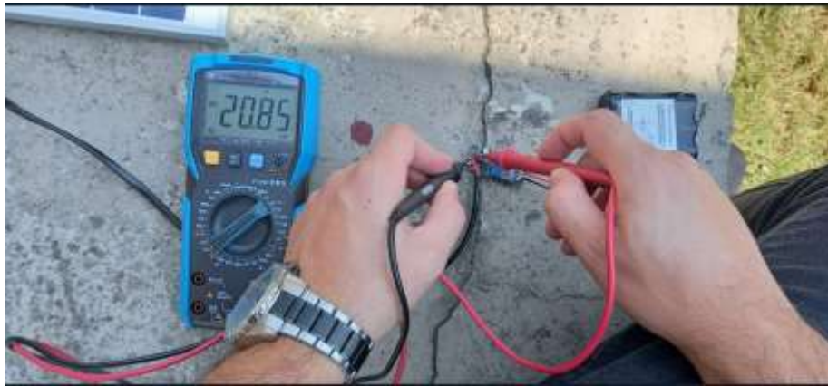
Figura 44 – Tensão de entrada da placa solar em ambiente externo 20,85 V
