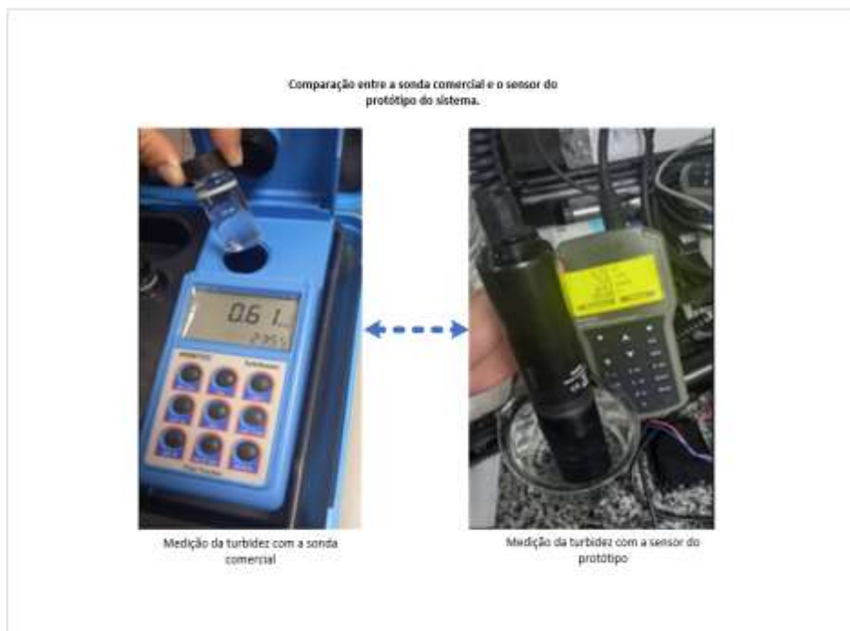
Figura 27 – Medição da turbidez na sonda comercial
