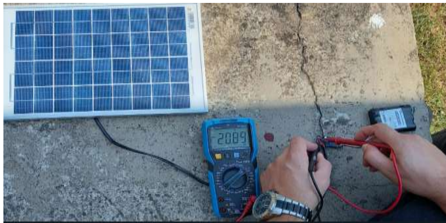
Figura 45 - Tensão de entrada da placa solar em ambiente externo 20,89 V
