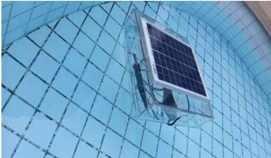
Figura 53: Protótipo mecânico estável após 30 min na água
