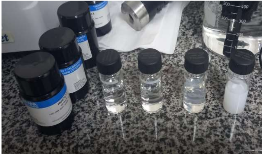
Figura 26 - Nível de turbidez entre 0 NTU e 150 NTU
