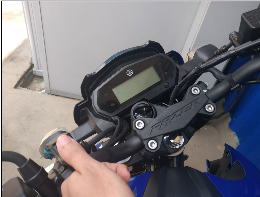
Figura 108: Teste de uma digital não cadastrada no sistema instalado na moto.
