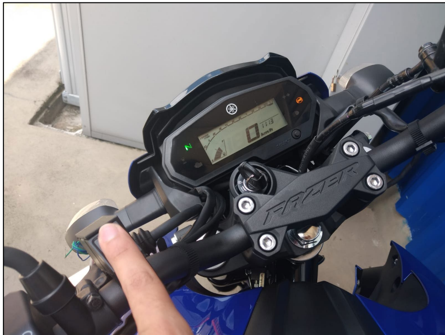
Figura 109: Teste de uma digital cadastrada no sistema instalado na moto.
