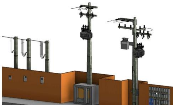
Figura 8 - Subestação aérea modelada utilizando REVIT
