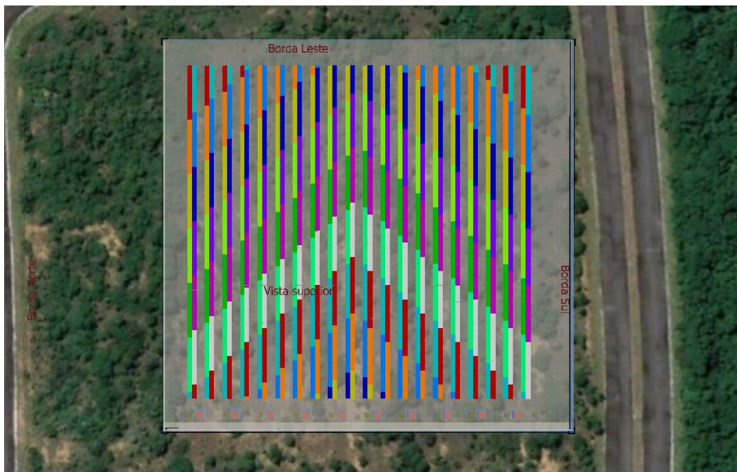
Figura 20 - Vista Geral da Usina com a distribuição de strings proposta pelo software
