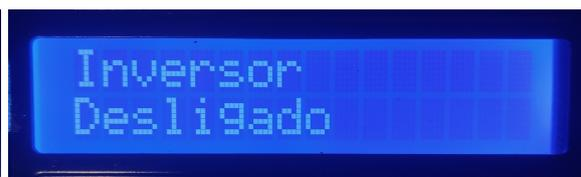
Figura 55 – Tela inversor desligado
