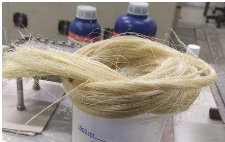
Figura 21 - Fibras de sisal pré-tratamento químico – Fonte: (Autor).
