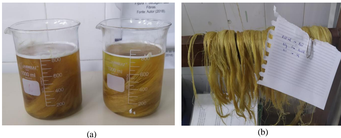
Figura 23 - (a) Tratamento de 4h e 10% de NaOH; (b) Secagem das fibras já tratadas – Fonte: (Autor).
