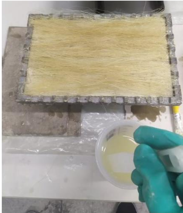
Figura 30 - Primeira aplicação da resina sobre o molde e distribuição das fibras – Fonte: (Autor).
