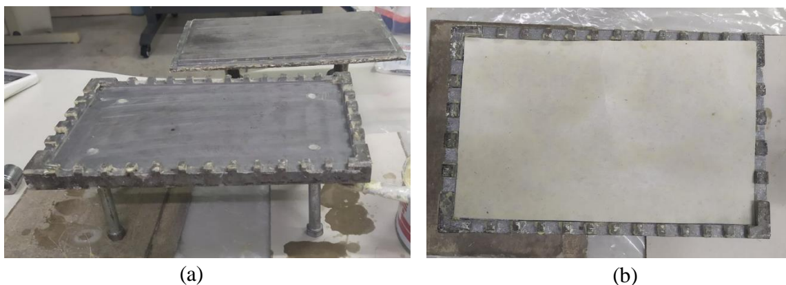
Figura 26 - (a) Molde utilizado na confecção do compósito; (b) Molde com papel paraná – Fonte: (Autor).
