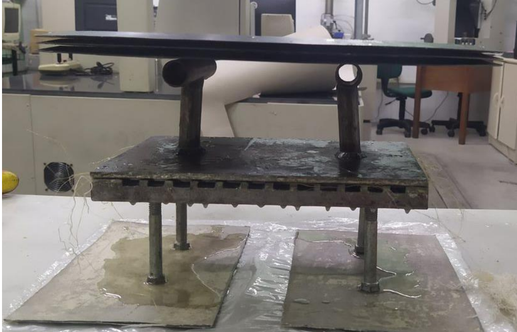
Figura 32 - Segunda aplicação da resina– Fonte: (Autor).
