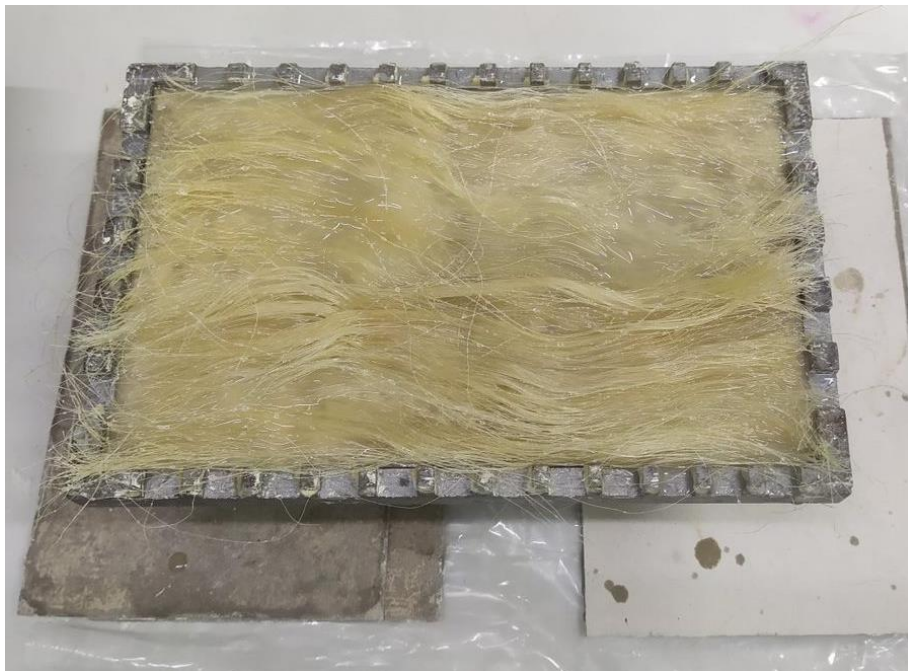
Figura 31 - Segunda aplicação da resina– Fonte: (Autor).
