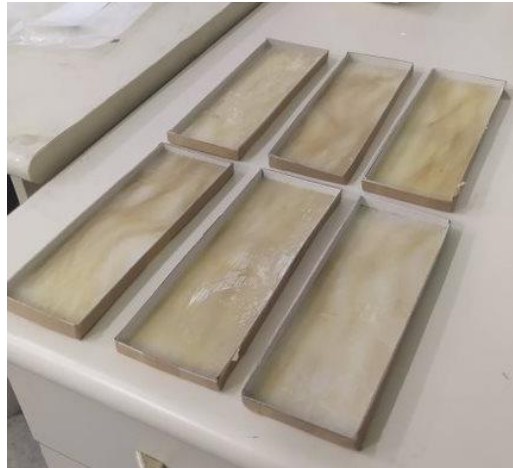
Figura 45 - Moldes prontos para o despejo da resina – Fonte: (Autor)
