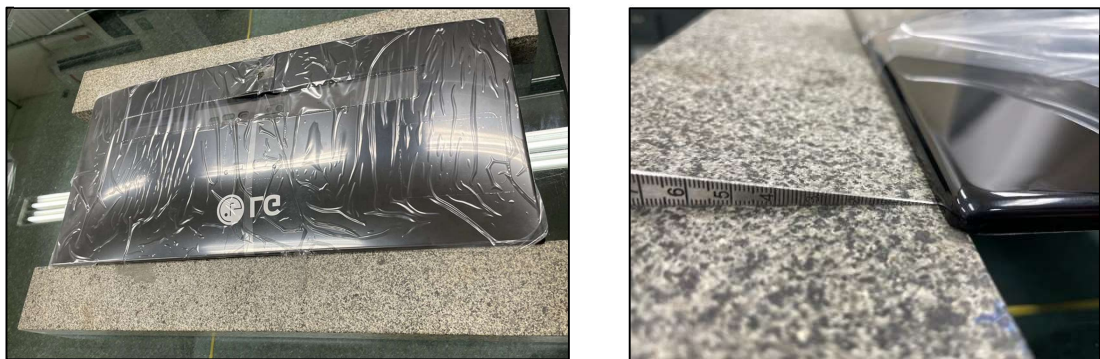
Figura 19 - Método de medição de planicidade
