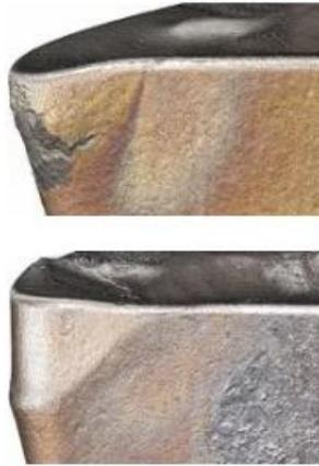
*Figura 15 – Desgaste de deformação plástica.*
