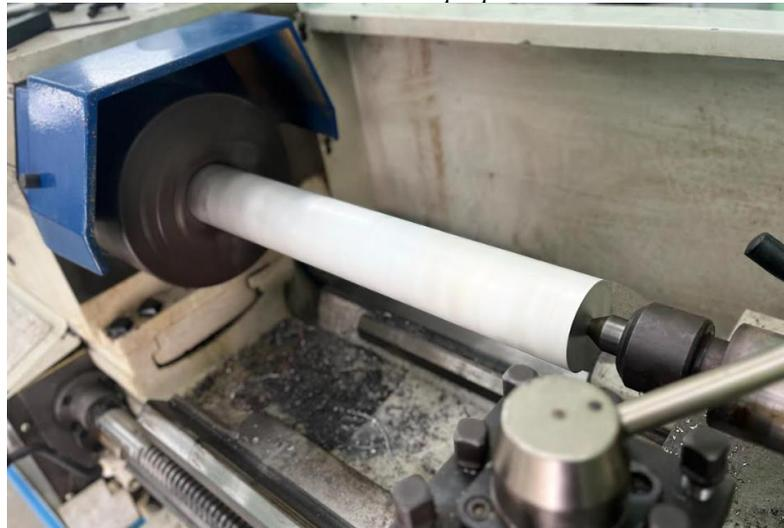
*Figura 26 – Tarugo montado entre pontas.*
