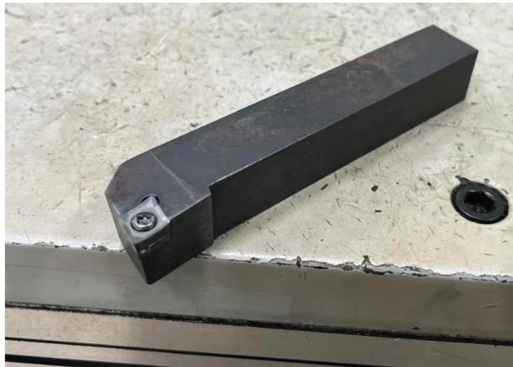
Figura 24 – Porta ferramenta com pastilha montada
