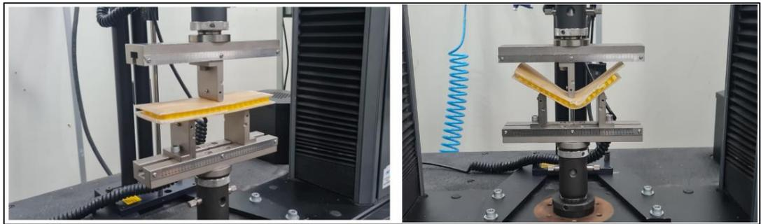
Figura 64 – CP #2: Teste de Flexão – Fonte: (Autor).
