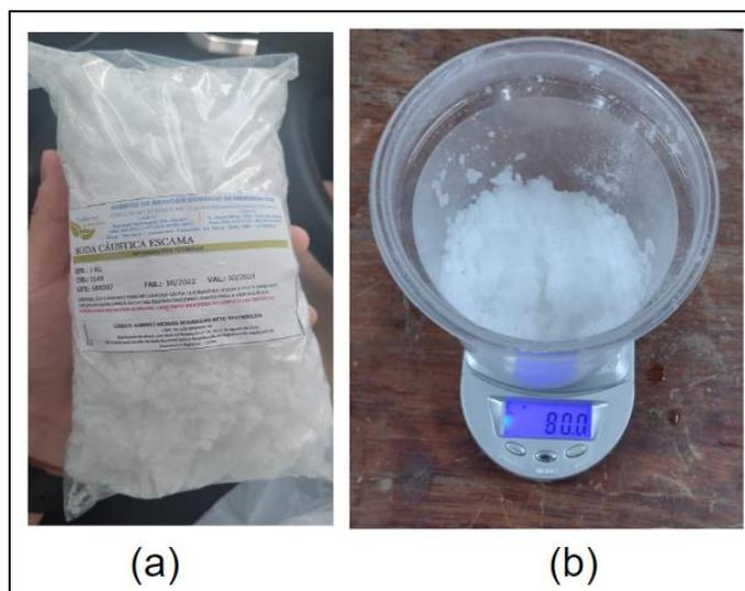
Figura 26 – (a) NaOH 98% em escamas; (b) Preparação de 80g de NaOH – Fonte: (Autor).
