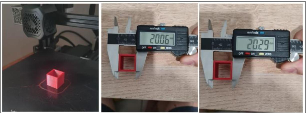
Figura 45 – Impressão e medição do cubo de calibração – Fonte: (Autor).
