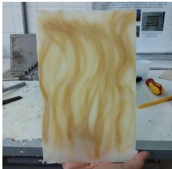
*Figura 38 – Placa de Sisal–Epóxi após lixamento – Fonte: (Autor).*
