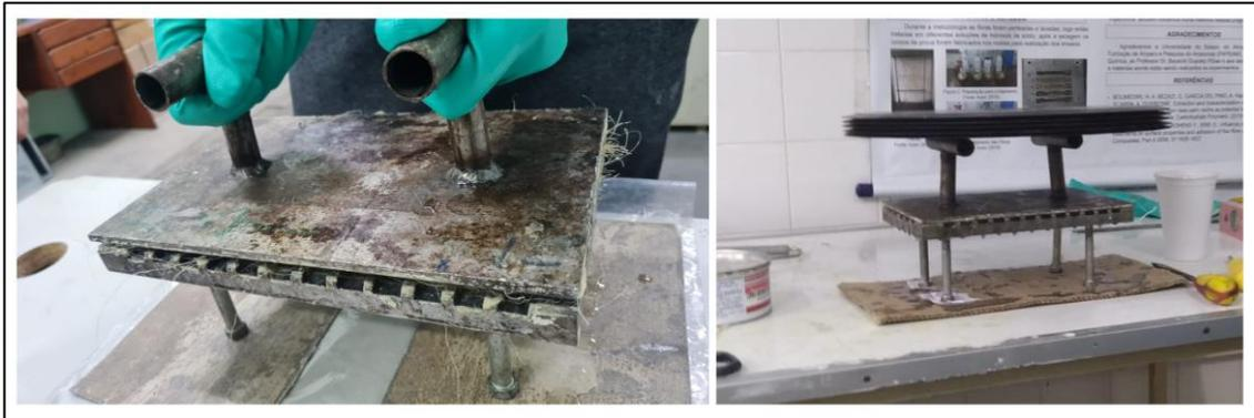
*Figura 36 – Aplicação da resina no molde – Fonte: (Autor).*
