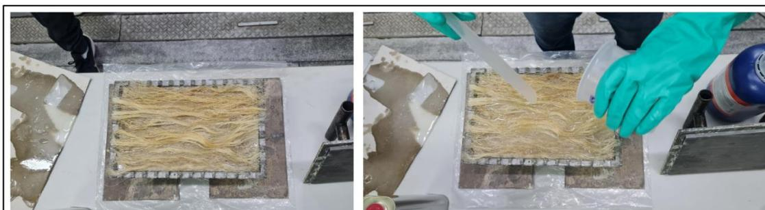
*Figura 35 – Aplicação da resina no molde – Fonte: (Autor).*
