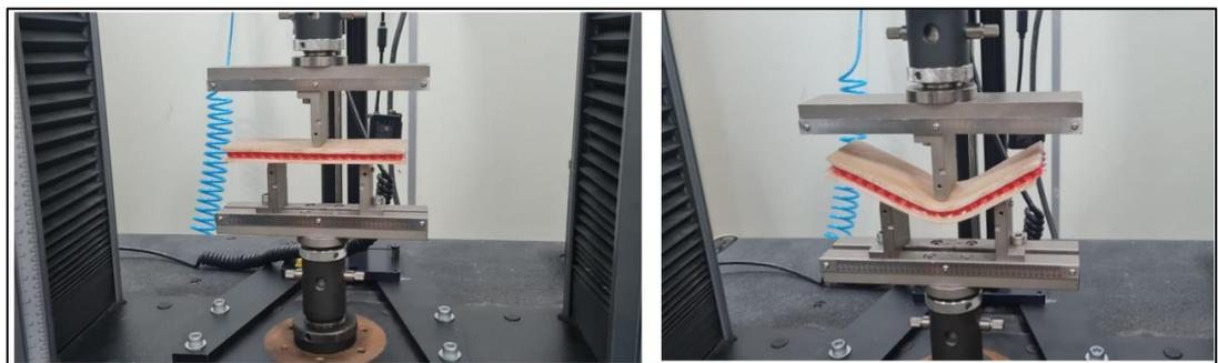
Figura 65 – CP #3: Teste de Flexão – Fonte: (Autor).
