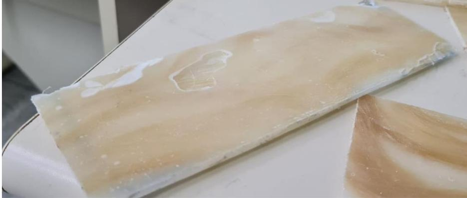
*Figura 61 – Face Reforçada, com Bolhas – Fonte: (Autor).*
