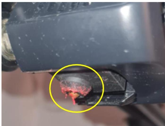
*Figura 60 – Bico Entupido – Fonte: (Autor).*
