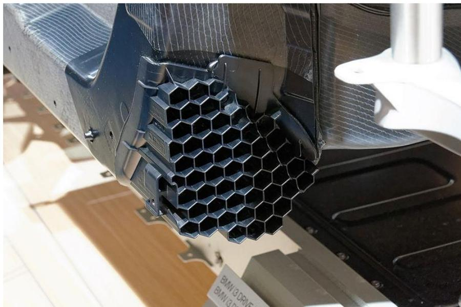
*Figura 16 – Estrutura de absorção de impacto em honeycomb feita de polímero termoplástico moldado por injeção em um BMW i3 – Fonte: (FLICKR, 2013).*
