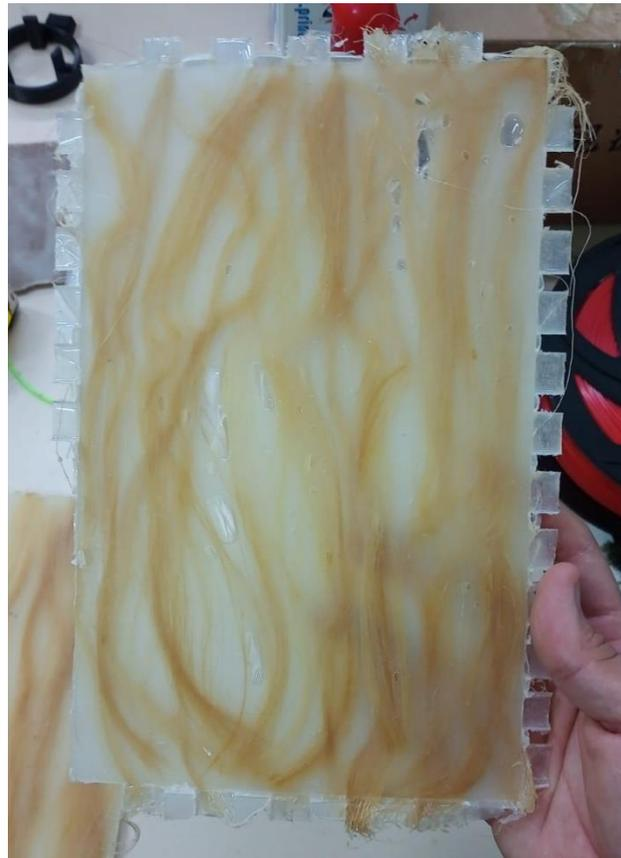
*Figura 37 – Placa de Sisal-Epóxi – Fonte: (Autor).*
