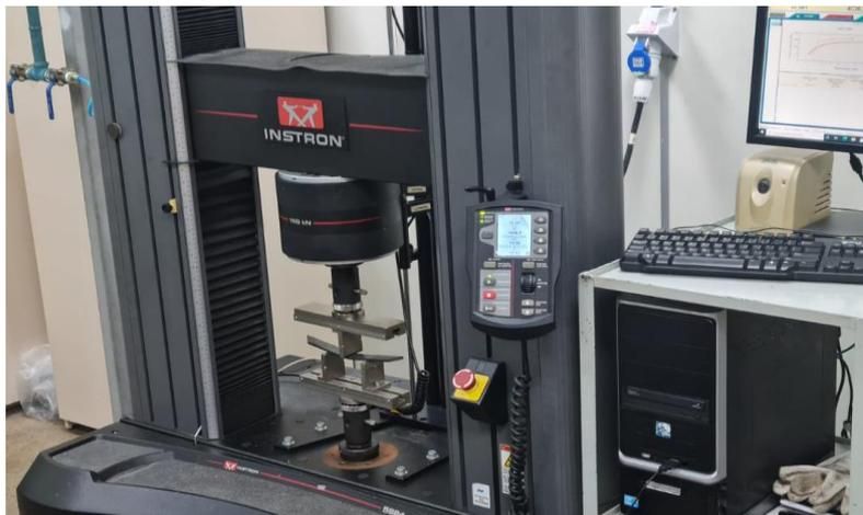
Figura 57 – Máquina de Ensaio de Flexão – Fonte: (Autor).
