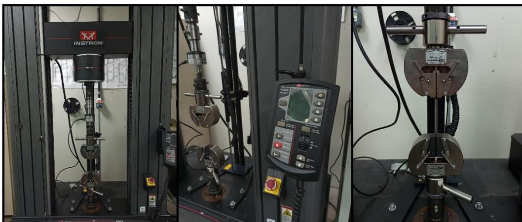
**FIGURA 25 – Máquina universal de ensaios – (Fonte: O Autor)**
