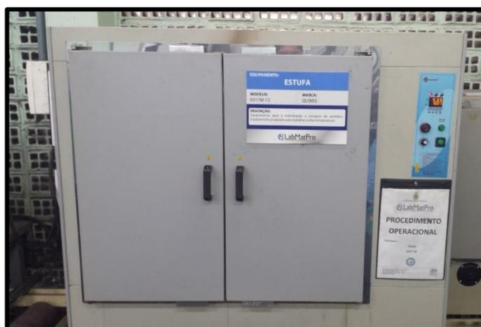
**FIGURA 16 – Cabine de estufa para a secagem total das fibras antes de serem inseridas nos moldes– (Fonte: O Autor)**
