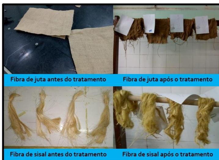
**FIGURA 14 – Fibras antes e depois dos tratamentos com NaOH – (Fonte: O Autor)**
