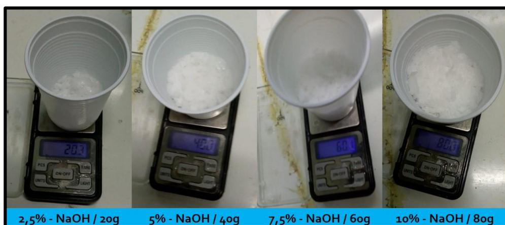
**FIGURA 13 – Pesagem das quantidades de NaOH para os tratamentos das fibras – (Fonte: O Autor)**
