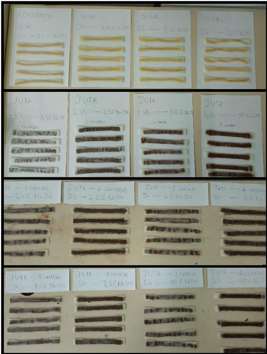
**FIGURA 26 – Corpos de prova organizados segundo seu percentual de tratamento e tempo – (Fonte: O Autor)**
