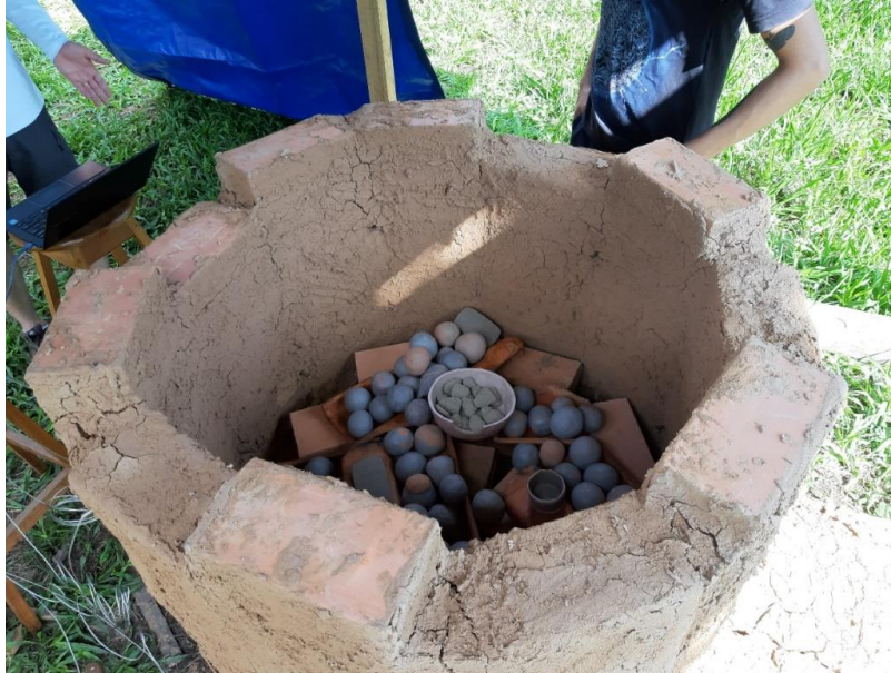
Figura 22. Carga dentro do forno.
