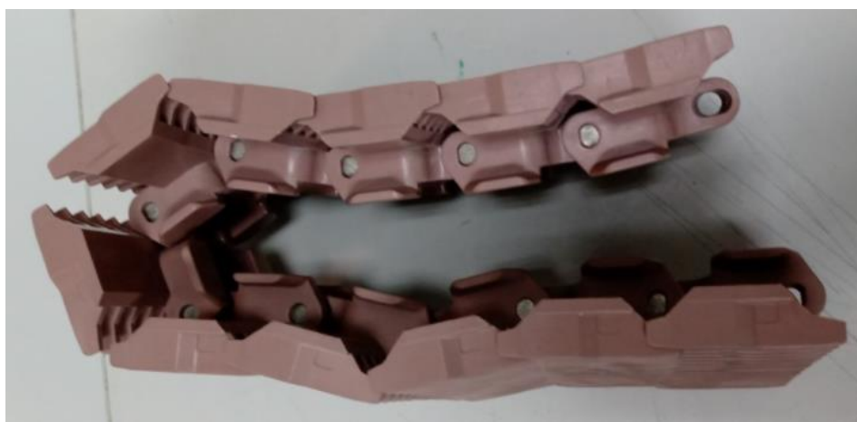
Figura 15 – Detalhe dos elos quebrados
