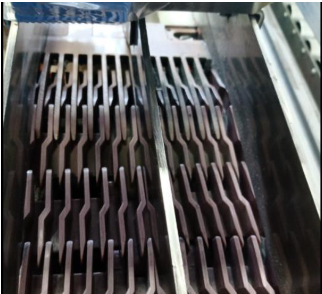
Figura 13 – Passagem da esteira transportadora para a esteira final
