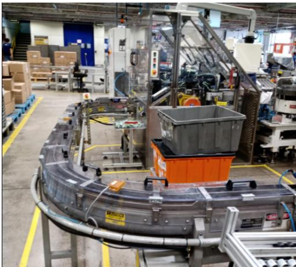
Figura 10 - Esteira transportadora de aparelhos de barbear
