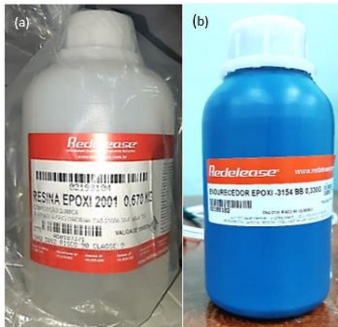
Figura 05: a) Resina epóxi 2001 e b) endurecedor 3154 (FONTE: Própria)
