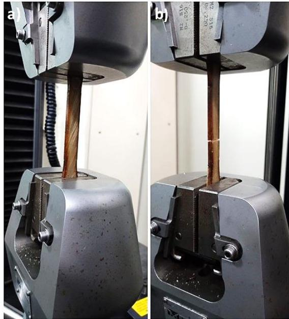
Figura 20: Corpo de prova muita fibra curauá (FONTE: Própria)
