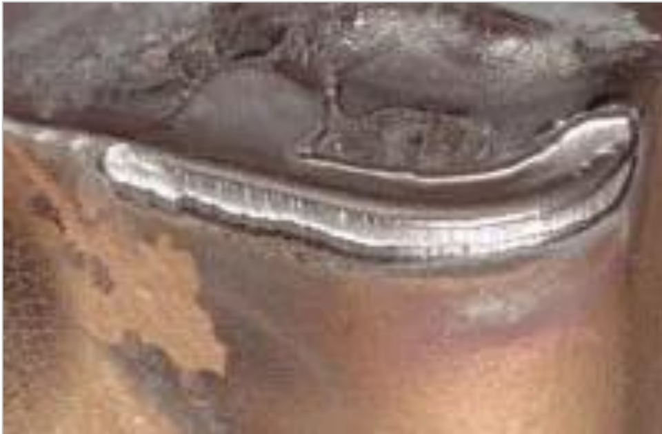
Figura 4 – Tipo de Desgaste de Flanco em uma ferramenta de corte
