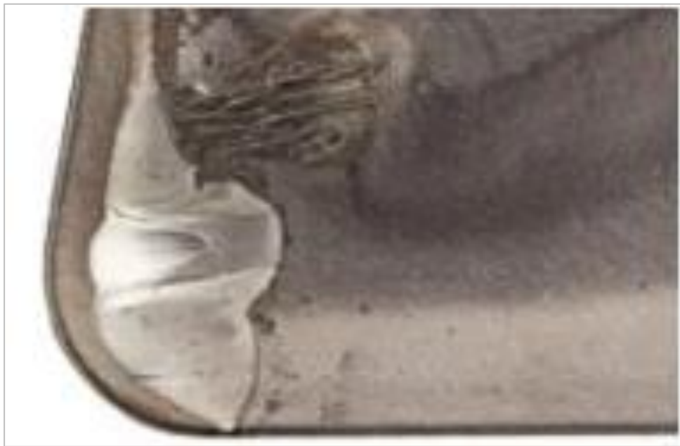
Figura 6 – Tipo de desgaste de cratera em uma ferramenta de corte
