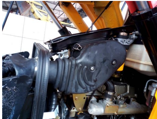
Figura 30: Filtro de ar já montado
