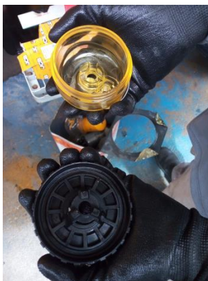
Figura 17: Tapa transparente do filtro separador após lavagem.
