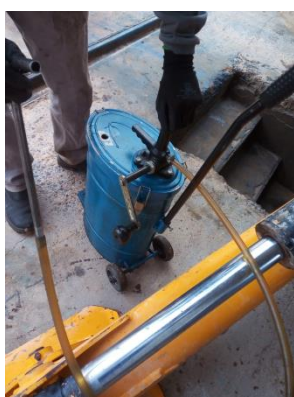
Figura 40 e figura 41: Bomba e mangueira para troca de óleo do Planetário
