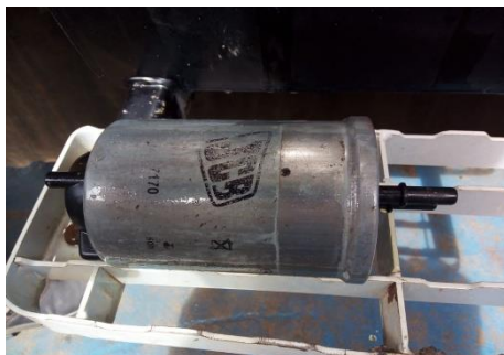
Figura 2: Filtro de combustível removido
