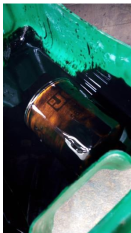
Figura 38: Filtro de óleo da transmissão removido
