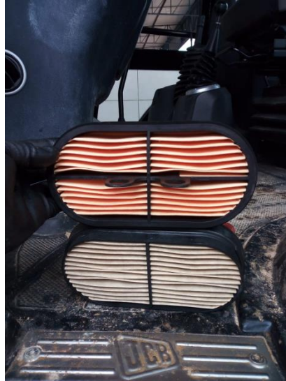
Figura 29: Comparação do filtro usado e o filtro novo.
