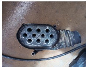
Figura 21: Guarnição admissão de ar do motor removido para limpeza.
