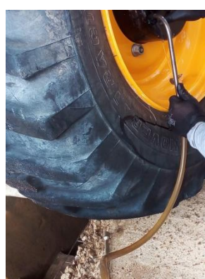
Figura 40 e figura 41: Bomba e mangueira para troca de óleo do Planetário
