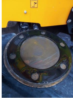
Figura 14: Junta da tampa do tanque para não vazar.
