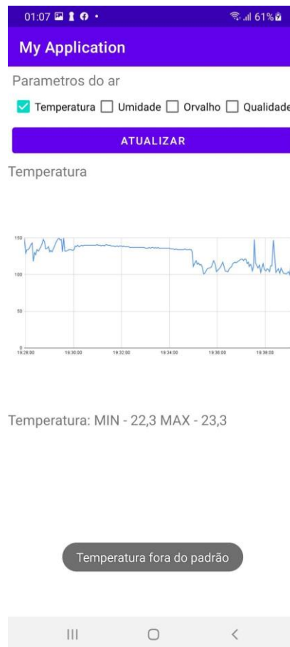
Figura 24 - Aplicativo mostrando notificação quando temperatura fica fora do padrão.
