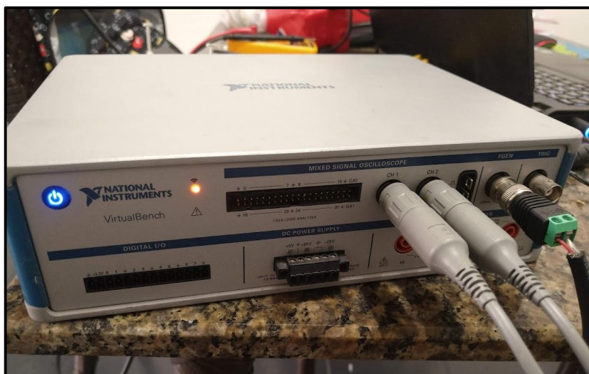
Figura 21 – Uso do NI VirtualBench All-in-One para testes funcionais do protótipo.
