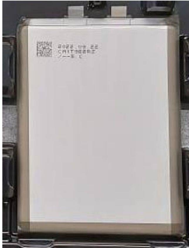
Figura 13: Célula após passar pelo processo de aplicação de fitas
