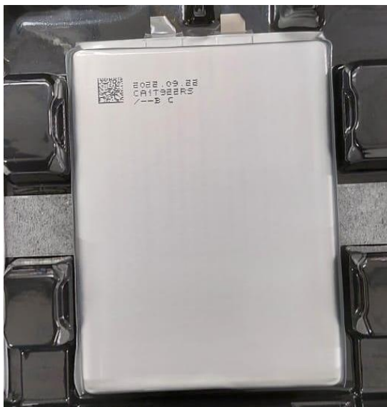
Figura 11: Célula após passar pelo processo de corte de terminais e inkjet
