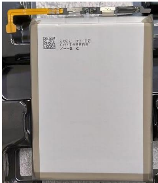
Figura 16: Célula após passar pelo processo de soldagem a laser
