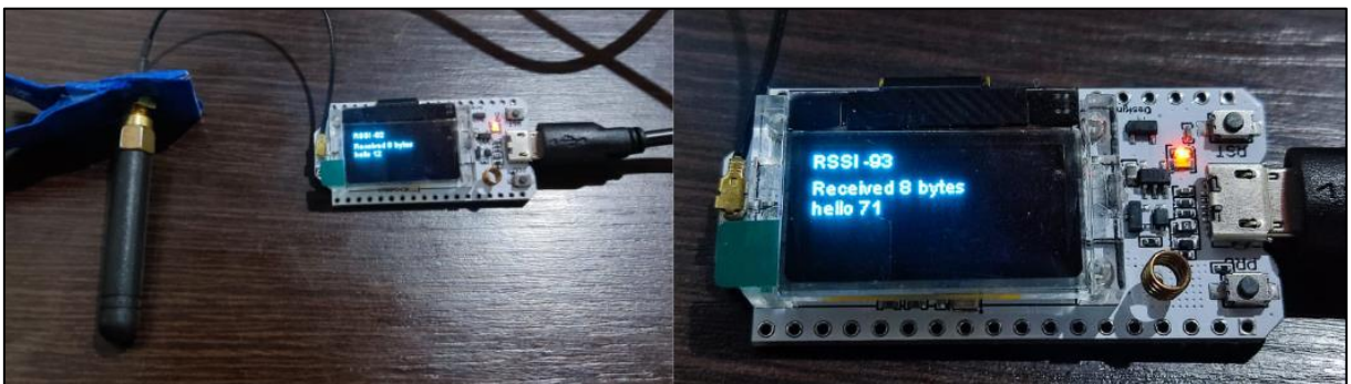
Figura 26: Módulo receptor recebendo pacotes via LoRa
