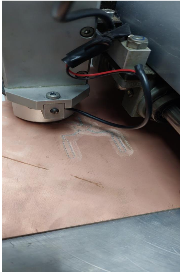
Figura 28 - Máquina CNC fresando placa de fenolite para criação do Layout da matriz de Antenas.
