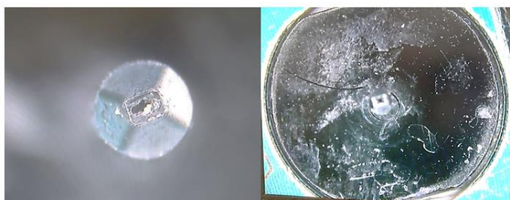
Figura 21 - Exemplos de defeitos em Nozzles
