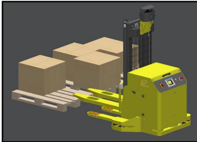
Figura 35 – Exemplo de como o LGV se posiciona na frente do pallet
