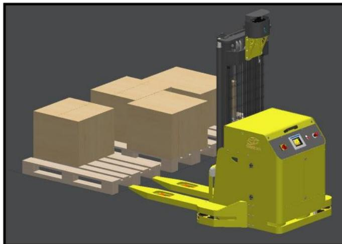
Figura 36 – Exemplo de como o LGV posiciona o garfo para pegar o pallet
