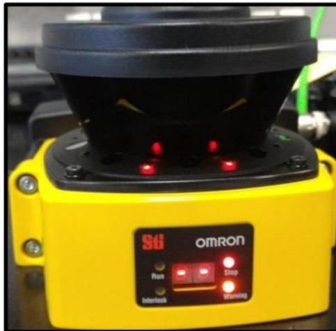
Figura 41 – Exemplo do Scanner Frontal e Traseiro
