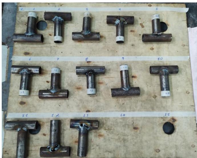
Figura 8 - Corpos de prova soldados do ensaio preliminar
