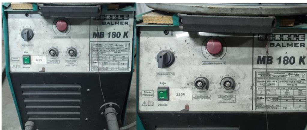
Figura 5 - Máquina de solda MB 180 K MERKLE-BALMER
