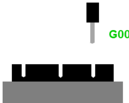
Figura 24: Esquematização da distância da ferramenta em G00 da superfície da peça
