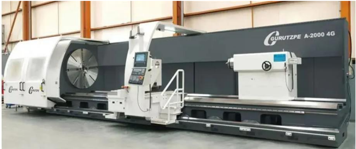
Figura 14: Gurutzpe máquina de usinagem de grande porte com programação CNC
