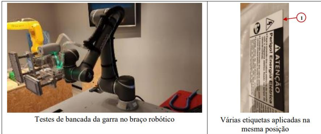
Figura 66 - Montagem em bancada da garra no braço robótico.
