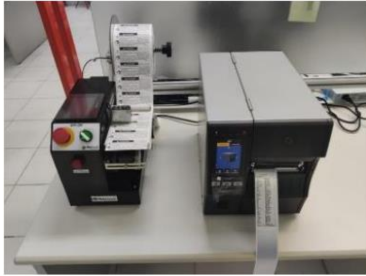
Figura 63 - Testes iniciais de funcionamento do dispensador e da impressora.
