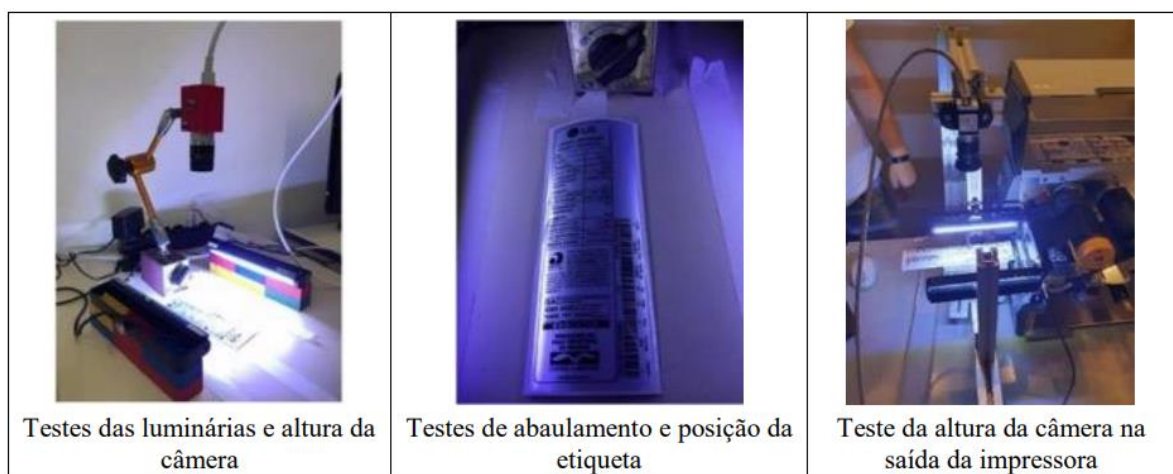
Figura 67 - Testes em bancada da iluminação e das câmeras.
