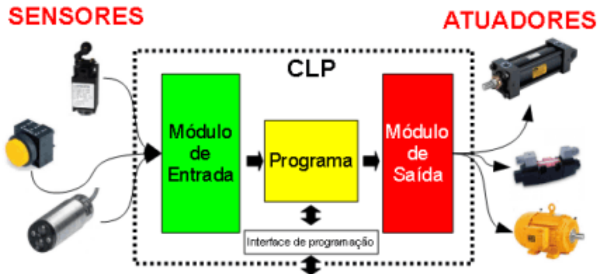
Figura 3 - Resumo da Arquitetura de um CLP
