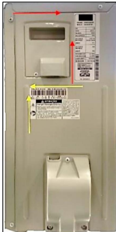
Figura 2 - Critérios de qualidade para o posicionamento das etiquetas no condensador
